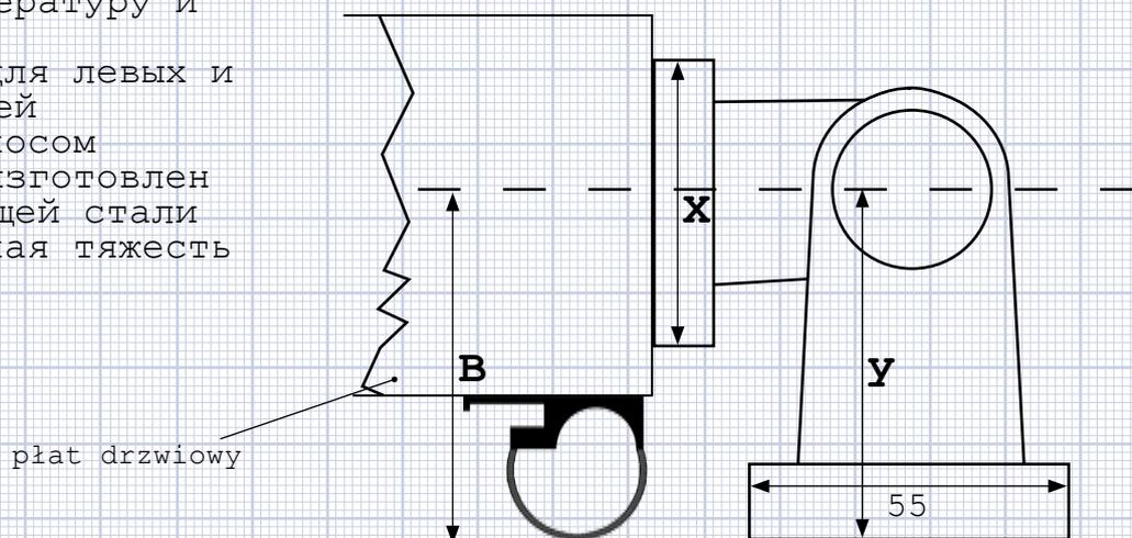
**B** - 1/2 grubości płyta + wysokość uszczelki
